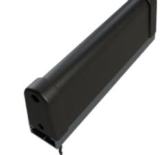
1. Damit sich die Sicherheitskontaktleiste problemlos montieren lässt, darf das Aluminiumträger-Profil nur auf ebenen Flächen montiert werden. Wird die Sicherheitskontaktleiste in einem Bogen montiert, darf der minimale Radius nicht unterschritten werden.
